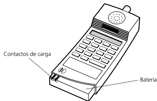
Fig. 2.153: NETCOM neris ONYX inalámbrico: Teléfono portátil
